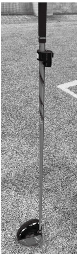
図4 センサーを装着したクラブ
